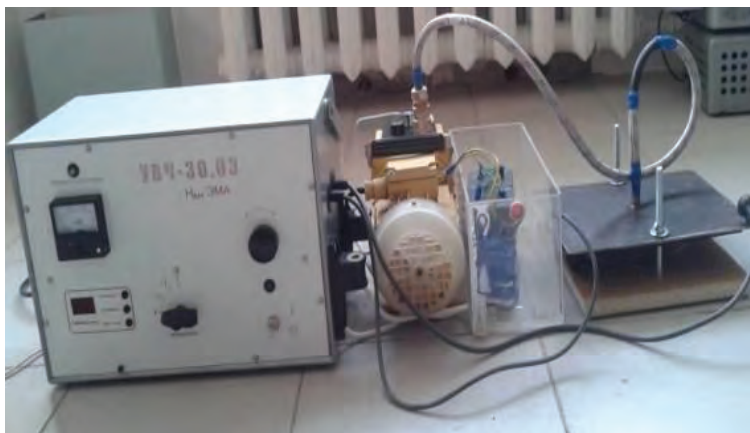
Рис. 1 (внешний вид лабораторной установки для газоразрядной обработки оптических изделий).
