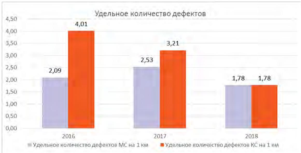
Рисунок 2 – Удельное количество дефектов тепловых сетей
