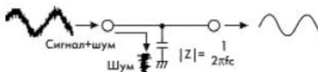
Рисунок 1 – Принцип работы емкостного фильтра
