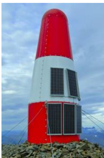
Рисунок 3 – Автономный радиоретранслятор «Габик»
