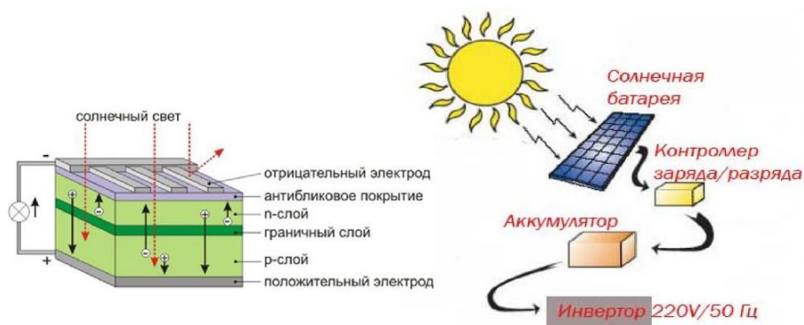
Рисунок 1 – Принцип работы солнечной панели
