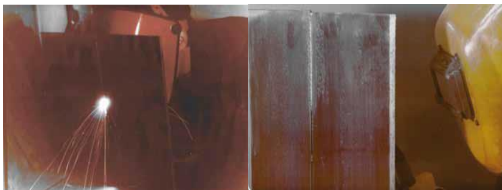
Рисунок 4 – Вертикальная адаптивная импульсно-дуговая сварка корневого шва
