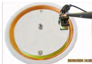
Рис.6. Установка с магнитами. Справа над диском обмотка
