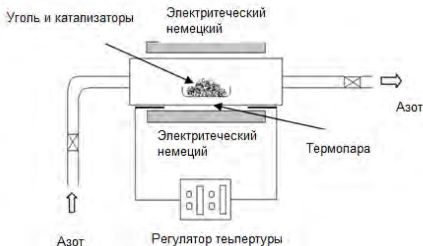
Рисунок 1 – Схематическая установка для синтеза наноструктур из угля УНВ; а — CNR; б.
