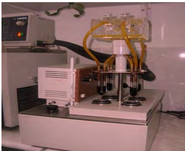
Рисунок 2 – Установка для определения ингибирующей эффективности ингибиторов парафиноотложений
