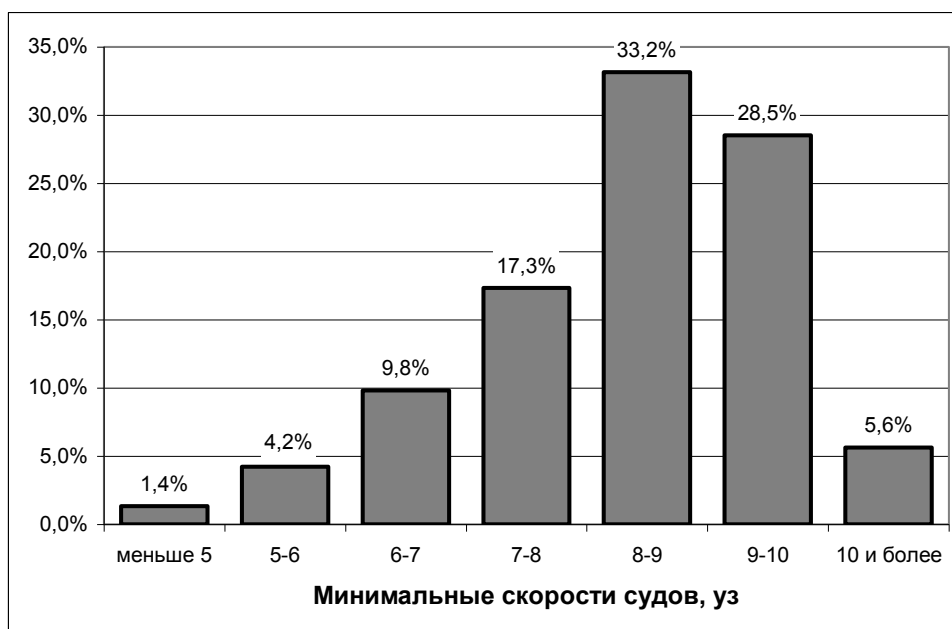
Рисунок 1 – Распределение минимальных значений скоростей судов при следовании по линии лазерного створа «Севастопольский» КМК
