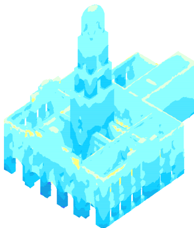
Рисунок 6 – Максимальные вертикальные напряжения в здании
