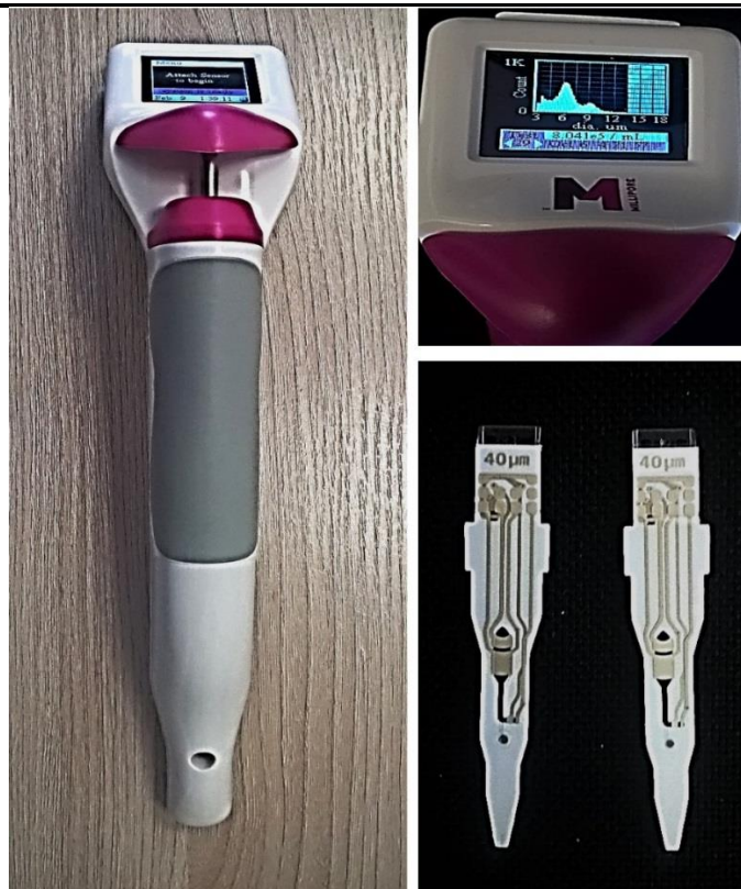
Рисунок 1 – Счетчик клеток Scepter™ 2.0 Handheld Automated Cell Counter с сенсорными наконечниками на 40 мкл (Merck Millipore)
