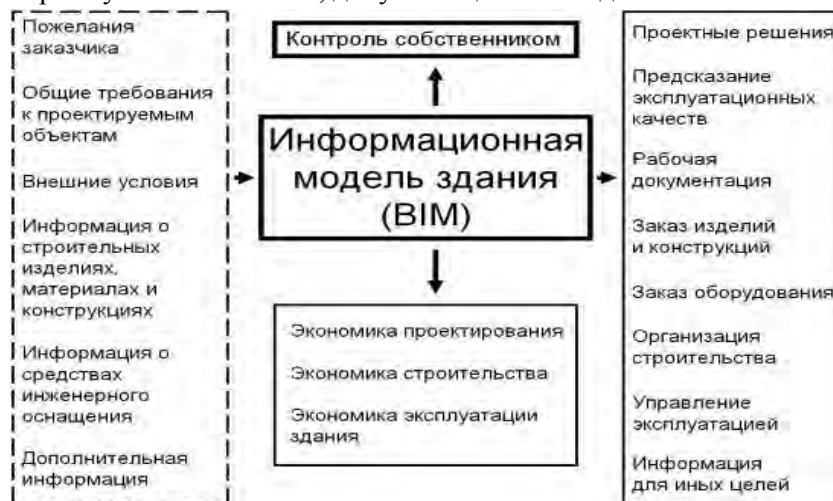
Рисунок 1 – Схема информации, относящейся к BIM, поступающей в модель и получаемой из неё
