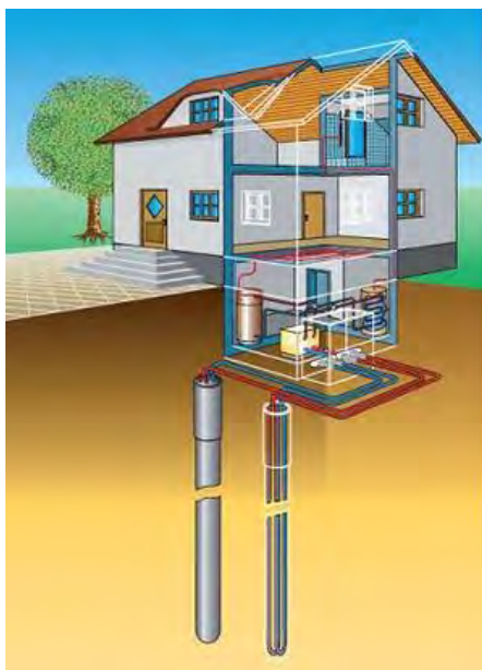
Рисунок 1 – Тепловой насос с вертикальными скважинами
