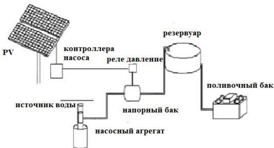
Рисунок 3 – Солнечная насосная система с прямой связью[1]
