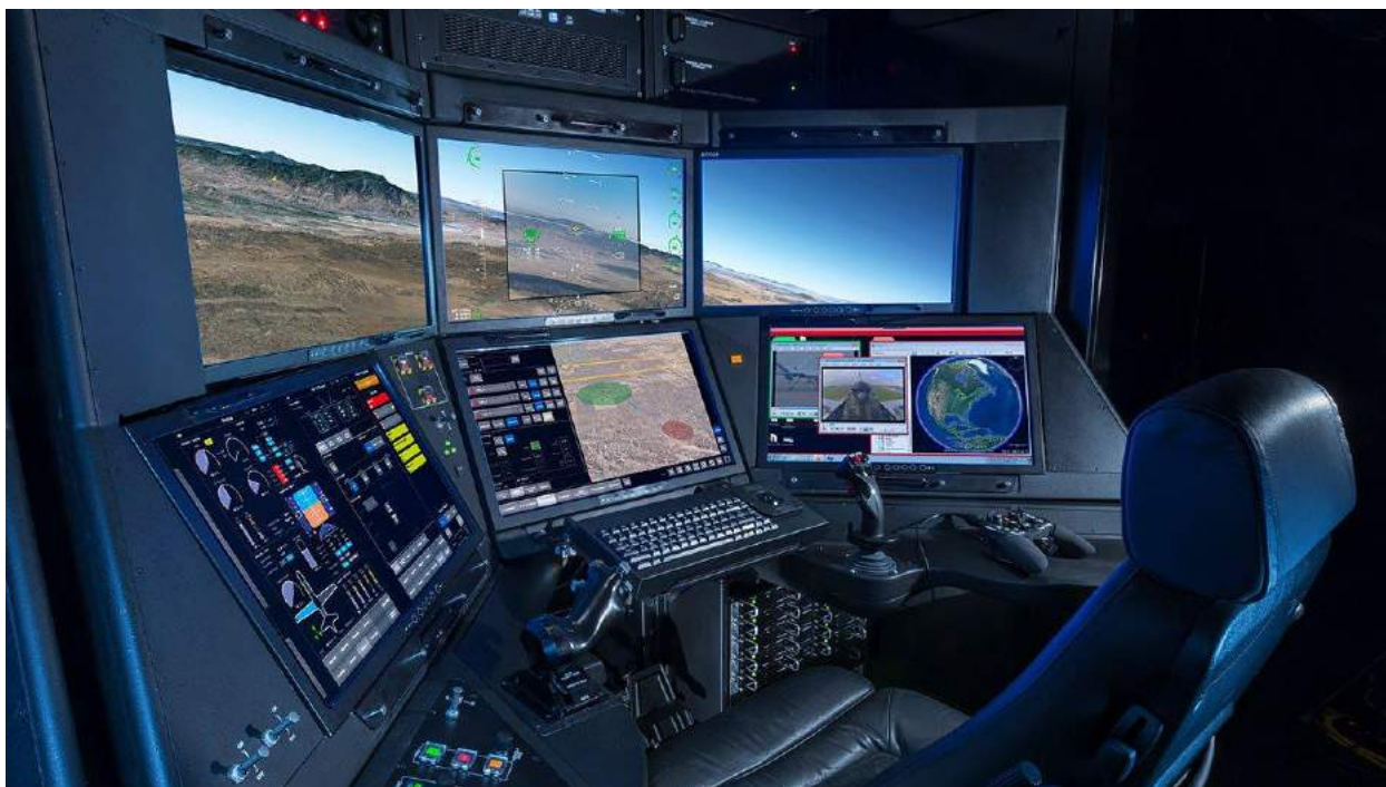
Рисунок 6 – Рабочее место оператора новой наземной станции управления General Atomics Aeronautical Systems Block 50 Ground Control Station (GCS) для управления беспилотными летательными аппаратами семейства General Atomics MQ-9 Reaper
