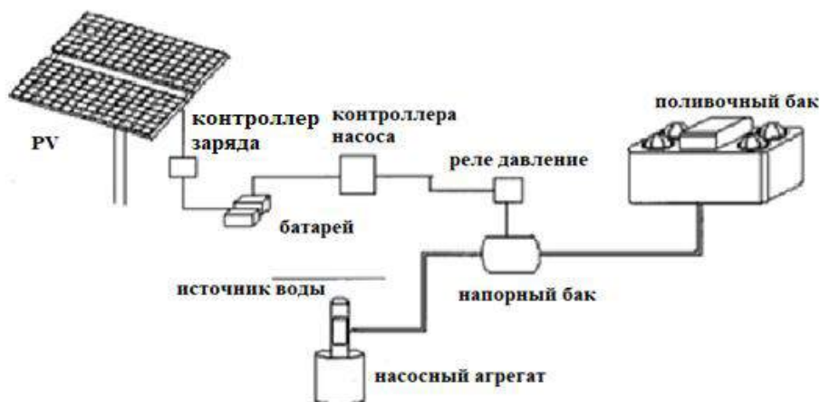
Рисунок 2 – Солнечная система перекачки воды с батарейным питанием[1]
