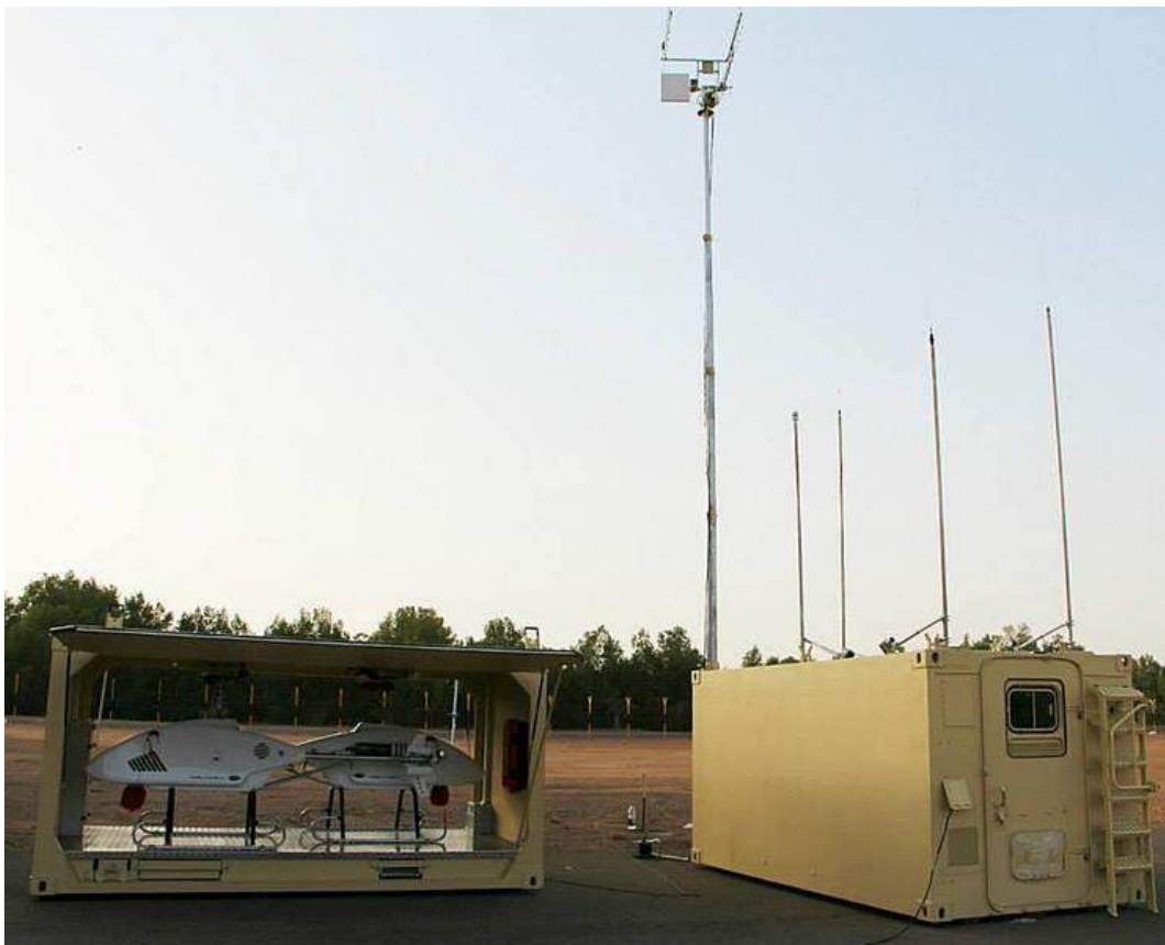
Рисунок 1 – Внешний вид передвижной станции управления белорусского БПЛА Indela.I.N.Sky
