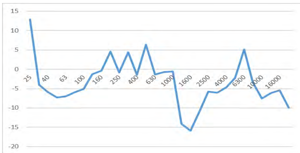
Рисунок 4 – Разность между глухим экраном и экраном с резонаторами
