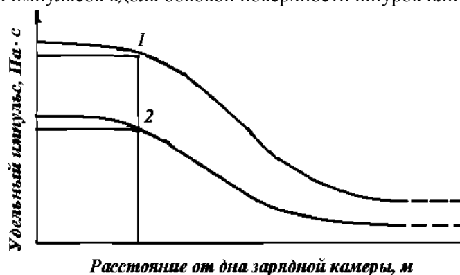
Рисунок 1 – Схема распределения удельных импульсов вдоль оси зарядной камеры удлиненной формы (по Ф. А. Бауму): 1- с забойкой; 2- без забойки.
