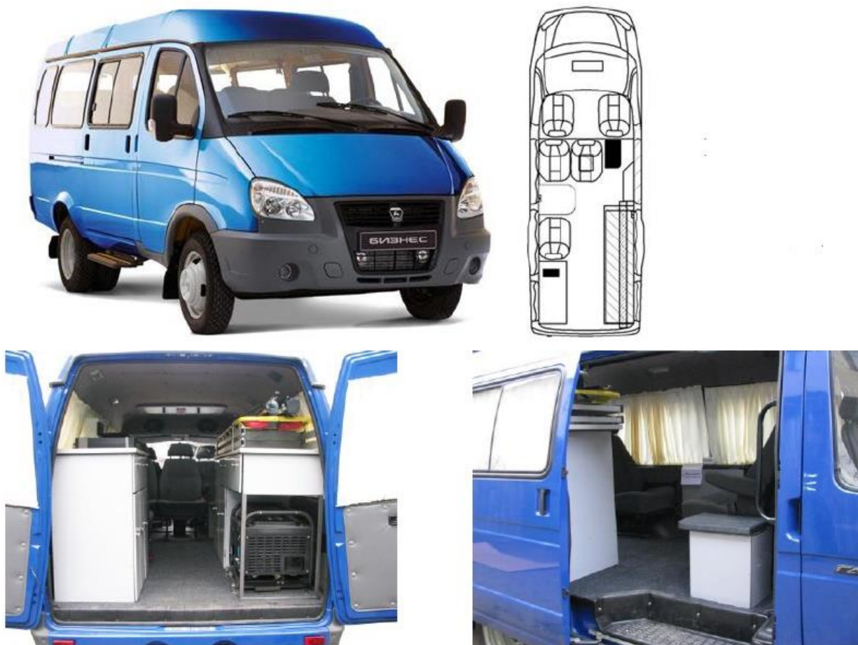
Рисунок 1 – передвижной кабинет охраны труда на базе автомобиля Газель
