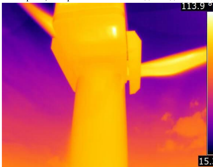
Рисунок 4 – Тепловизионные и высокоточные снимки беспилотных летательных аппаратов обычно обеспечивают более детальный и точный осмотр лопастей и башен ветротурбин
