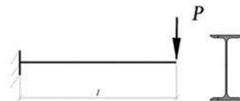
Рисунок 3 – Консольная балка, нагруженная сосредоточенной силой
