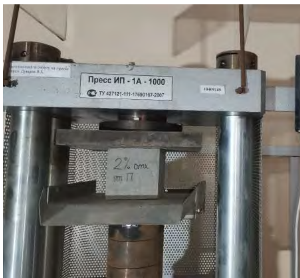
Рисунок 2 – Испытание образца с использованием отходов углебогатительных предприятий на осевое сжатие на испытательной машине-прессе
