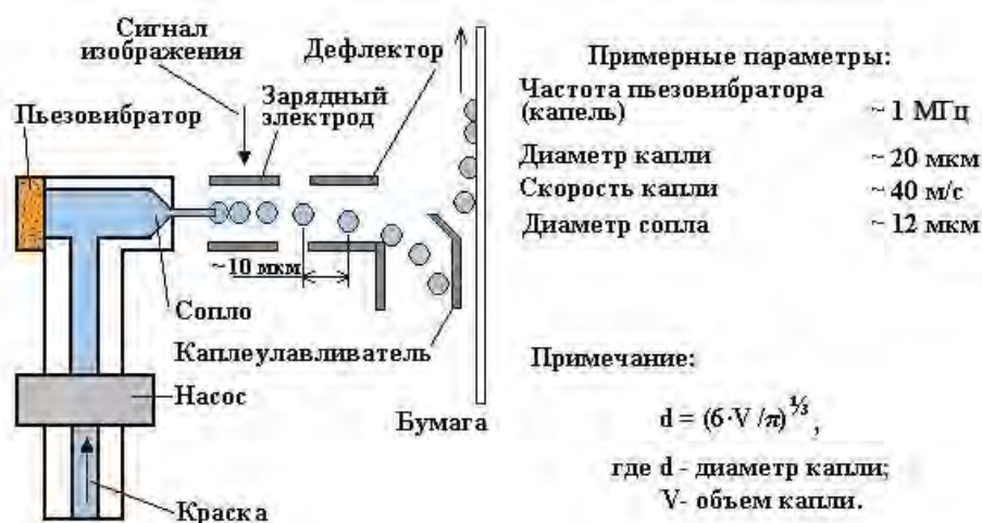
Рисунок 3 – Струйная печать непрерывного действия
