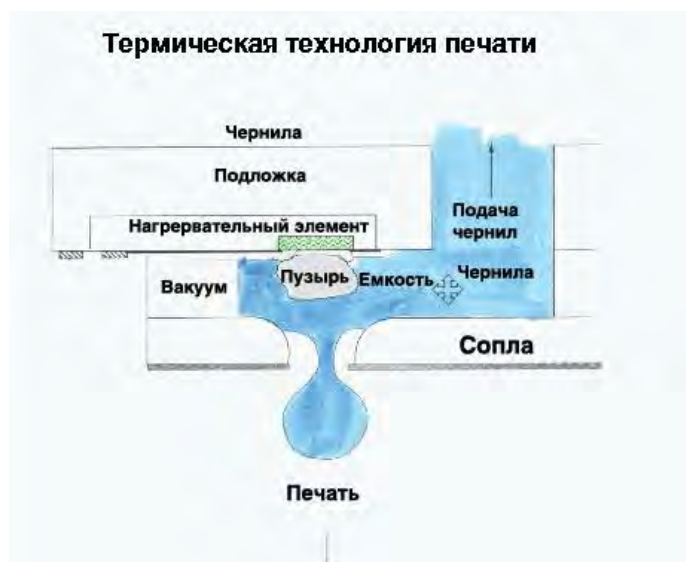
Рисунок 2 – Принцип работы принтера
