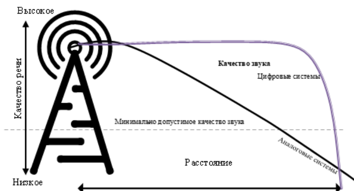
Рисунок 1 – Принцип построения сети радиосвязи с использованием DMR
