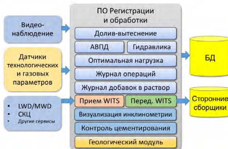
Рисунок 2 – Блок-схема передачи данных
