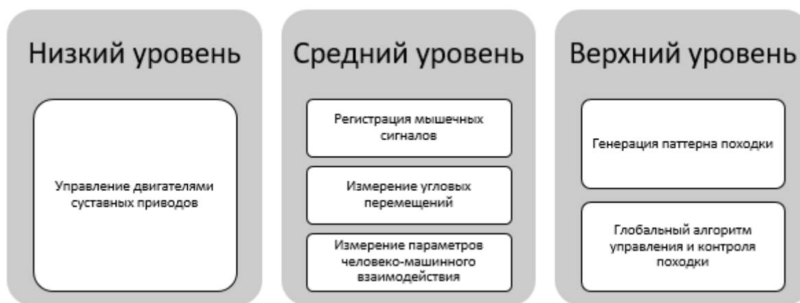
Рисунок 1 – Структура системы управления экзоскелетом
