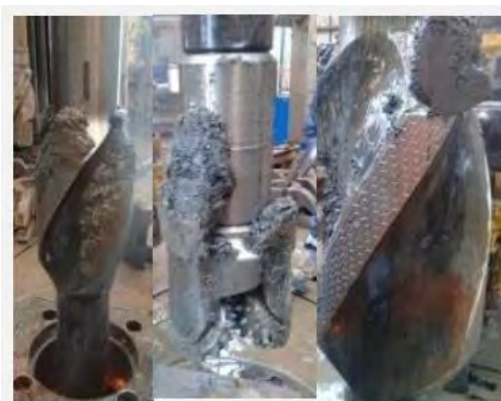
Рисунок 7 – Минимальное образование сальников при применении полимеркатионного бурового раствора
