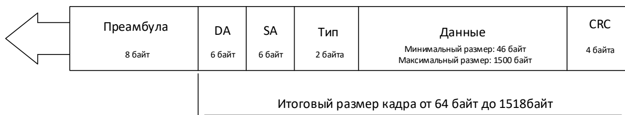
Рисунок 1 – Структура Ethernet фрейма
