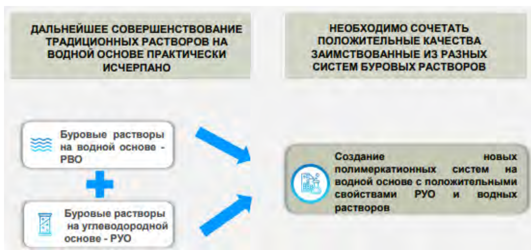
Рисунок 6 – Базовая концепция создания полимеркатионных буровых растворов
