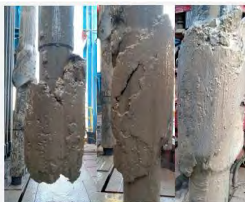
Рисунок 8 – Образование сальников при применении традиционного бурового раствора
