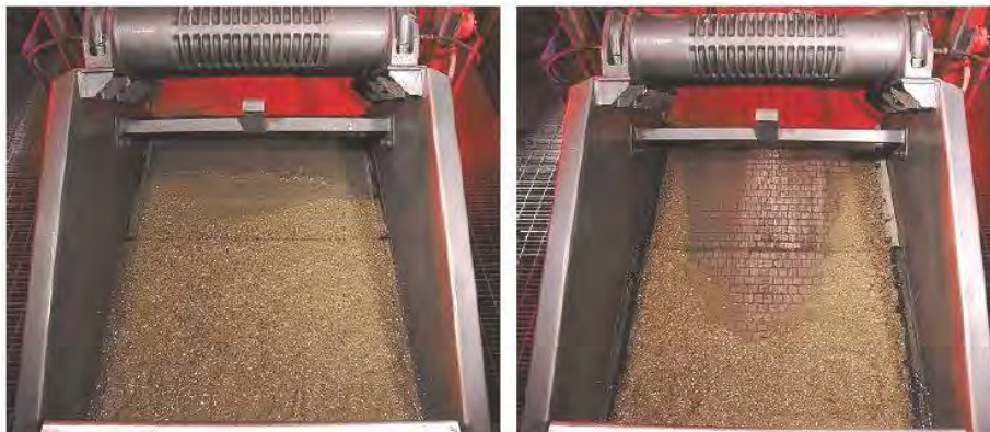
Рисунок 5 – «Эффект подковы» натяжной сетки вибросита Mongoose HS компании «M-I Swaco»
