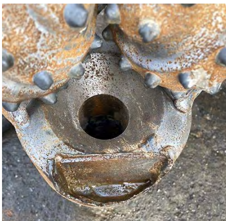
Рисунок 3– Слом лапы на долоте корпусного типа при повторном использовании инструмента
