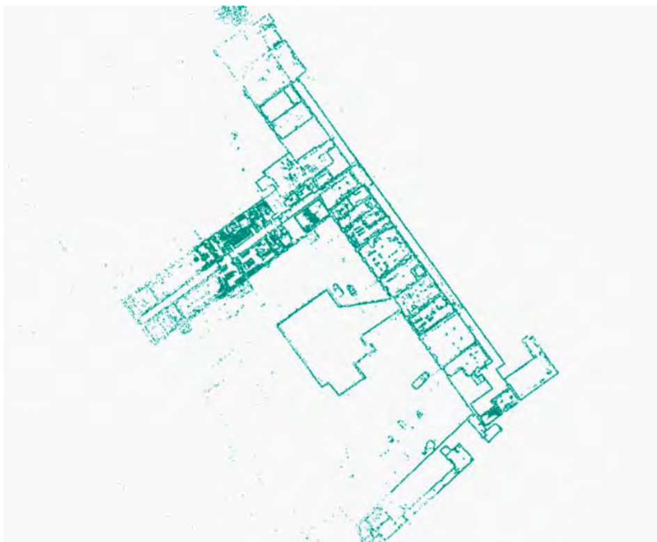
Рисунок 10 – Обмерный план по результатам лазерного сканирования
