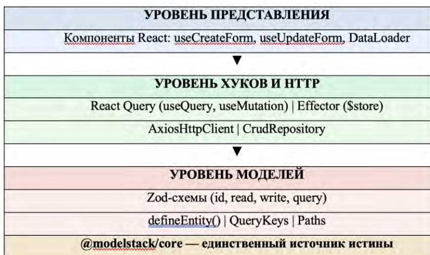
Рисунок 1 – Архитектура ModelStack: трёхуровневая модель
