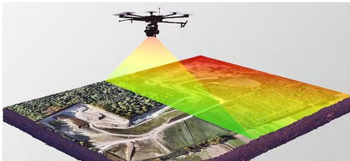
Рисунок 5 – Сканирование местности с помощью воздушного лазерного сканера
