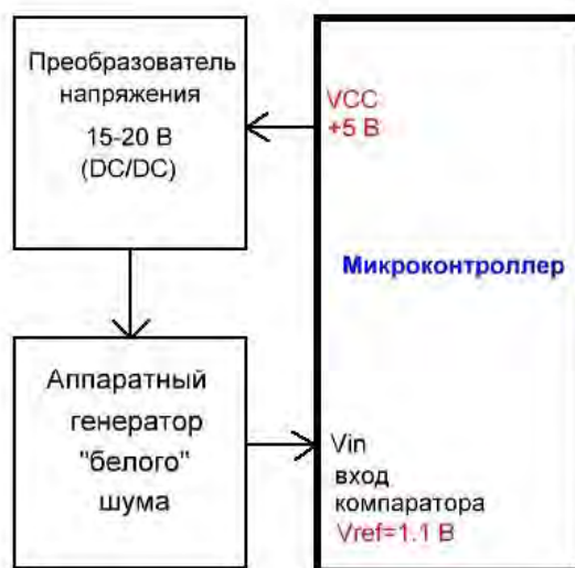
Рисунок 1 – Структурная схема программно-аппаратной генерации случайных чисел в микроконтроллере
