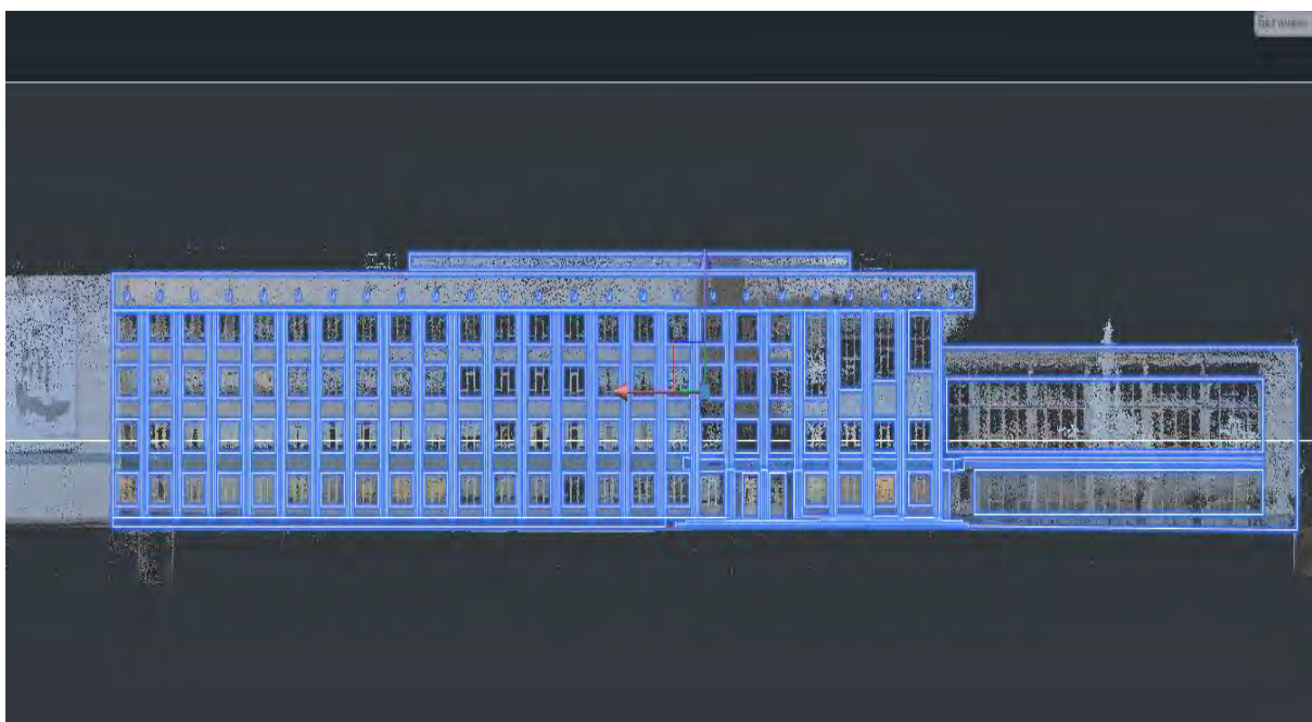
Рисунок 9 – Чертеж фасада здания на основе облака точек
