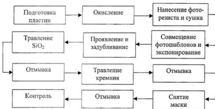
Рисунок 1 – Этапы изготовления кремниевой пластины
