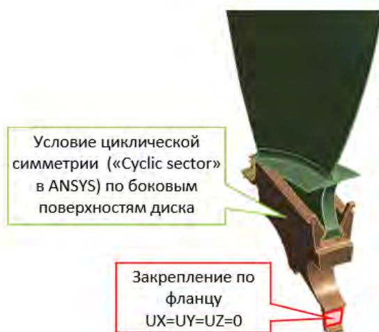
Рисунок 2 – Расчетная модель РК вентилятора
