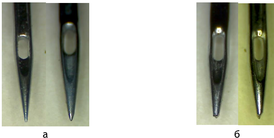
Рисунок 4. Швейные иглы острые (а) и с износом острия иглы (б)
