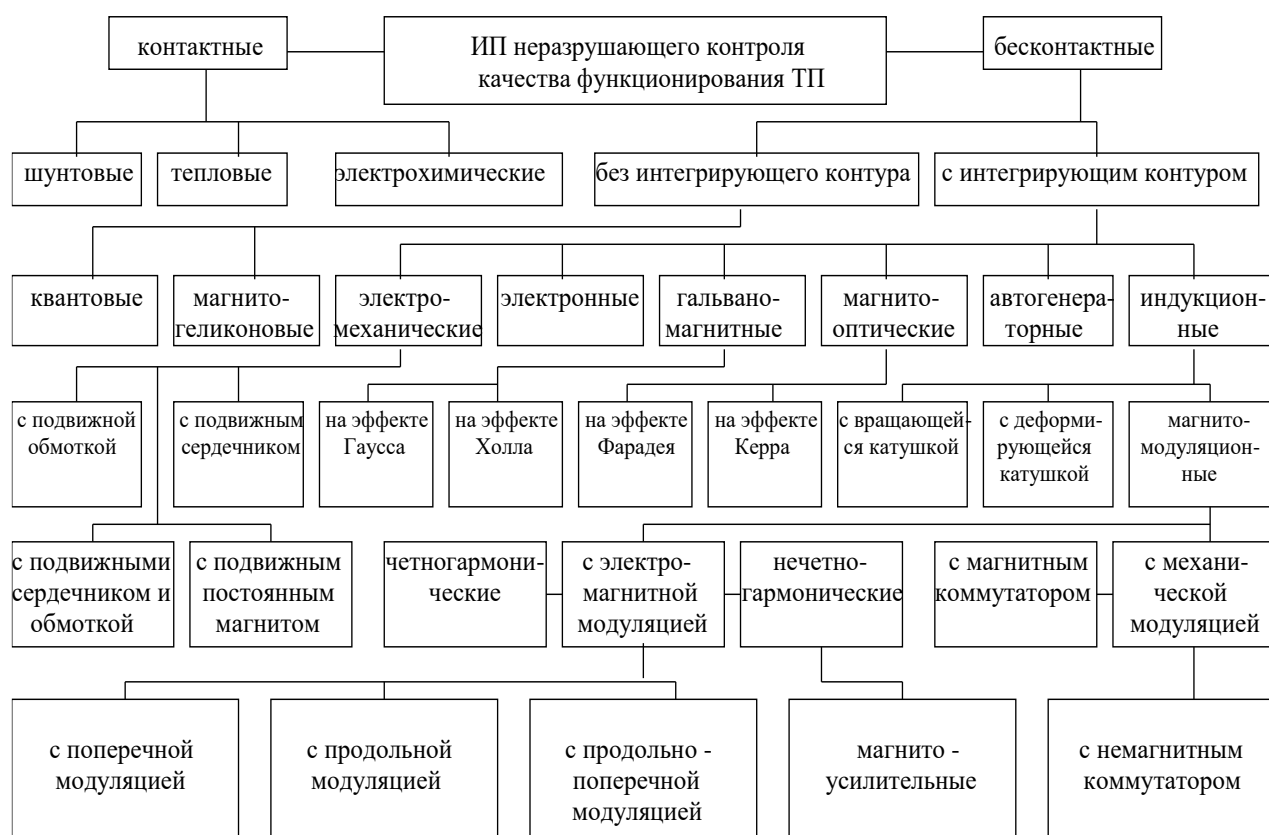
Рис. 1. Классификация измерительных преобразователей неразрушающего контроля больших постоянных токов
