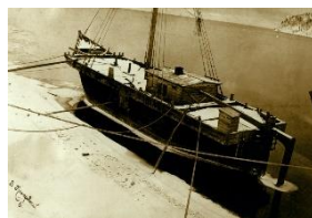
Рис. 3. Паузок иркутский. Набор у этого судна как у небольшой палубной баржи с навесным рулём [20]
