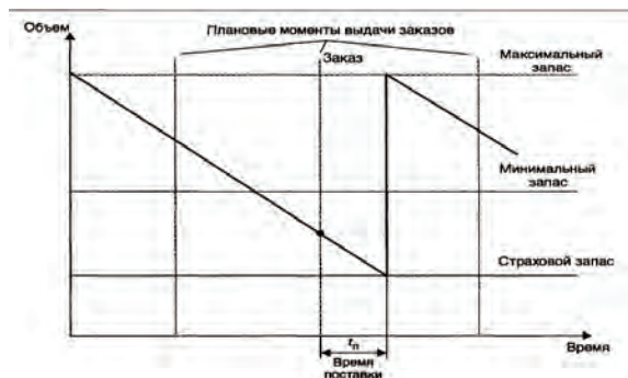
Рисунок 3 - Иллюстрация движения запаса в модели «минимум - максимум»
