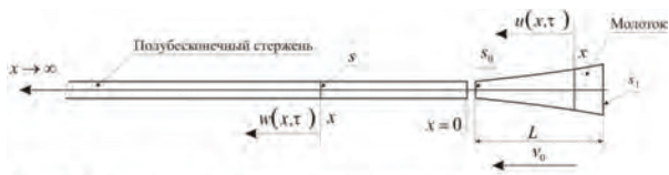
Рис. 1. Расчетная схема к задаче генерирования импульса продольной динамической деформации молотком имеющим форму пауэра
