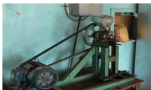
Рисунок 1 - Общий вид и схема лабораторного пресс - экструдера ХР - 3
