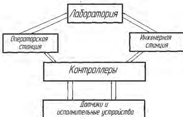
Рисунок 2. Архитектура системы автоматизации
