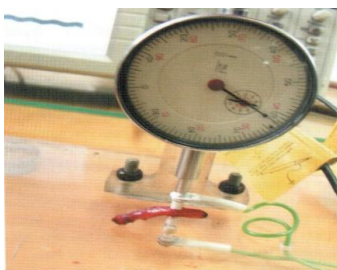
Рис. 1. Испытание на прочность электросварное шов выдерживает давление воды 625 мм. р. Ст.
