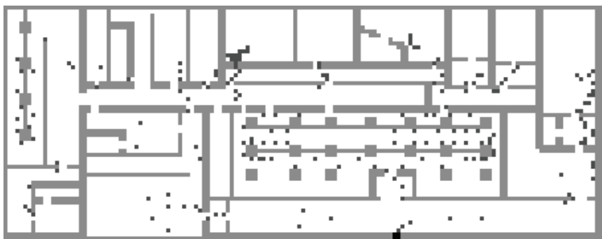
Рис. 1. Мультиагентная модель эвакуации из произвольно взятого здания на одной из итераций.
