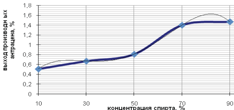
Рисунок 2. Зависимость выхода производных антрацена от концентрации элюента
