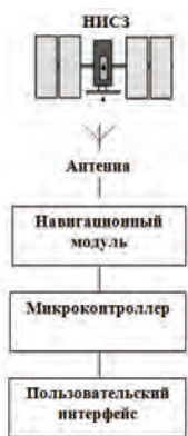
Рисунок 1 - Общая схема работы лабораторного стенда электронного компаса на основе ГНСС
