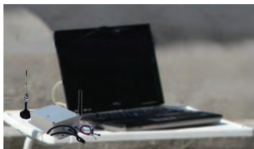
Рисунок 2 – Лабораторный стенд электронного компаса на основе ГНСС
