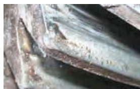
Рисунок 6. Пластические сдвиги на рабочей поверхности зубчатой передачи — напряжения на площадках контактов превысили предел текучести: а) начальная стадия; б) дальнейшее развитие.
