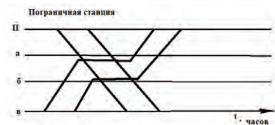
Рисунок 3 – Характер пропуска поездов при наличии вставки второго главного пути на одном перегоне а – б
