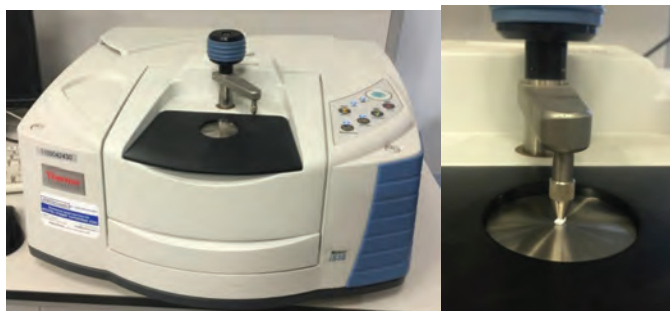
Рисунок 3. ИК - Фурье спектрометр Nicolet iS10 INTERTECH Corporation
