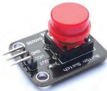
Рисунок 1 – Модуль - кнопка для блока сигнализации ИСОМП
