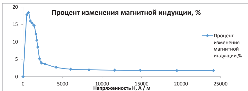
Рис. 2. Процент изменения магнитной индукции при параллельном включении испытуемого образца в магнитную цепь
