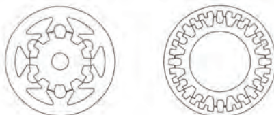
Рисунок 3. Конфигурация магнитной системы с двумя зубцами на полюс статора
