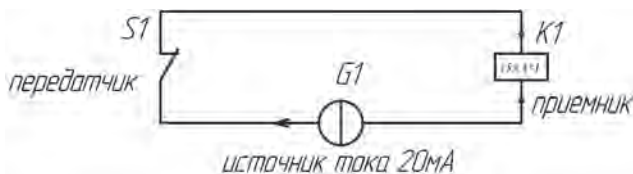
Рисунок 2. Принцип работы токовой петли.
