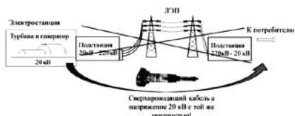
Рисунок 2 – Возможное изменение инфраструктуры передачи электроэнергии с использованием ВТСП силовых кабелей
