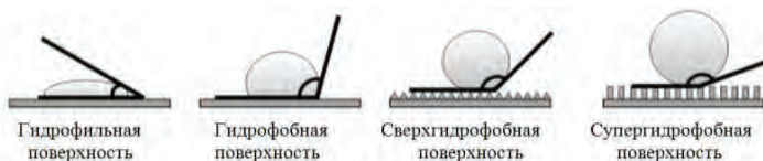
Рисунок 2 - Модели гидрофильной ( 0^\circ < \Theta < 90^\circ ), гидрофобной ( \Theta > 90^\circ ), супергидрофобной ( 120^\circ < \Theta < 150^\circ ) и супергидрофобной ( 150^\circ < \Theta < 180^\circ ) поверхностей, где \Theta - контактный угол смачивания [3]
