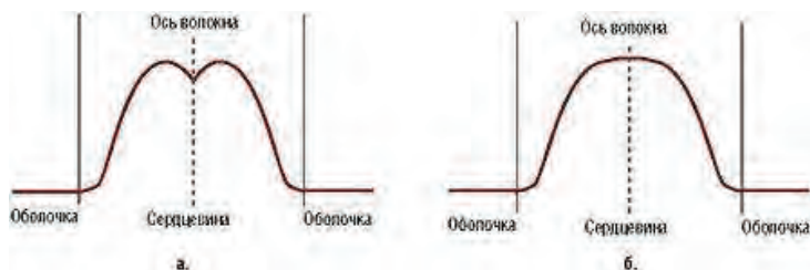
Рисунок 2. Профиль показателя преломления многомодовых световодов: а — стандартное волокно; б — широкополосное волокно.
