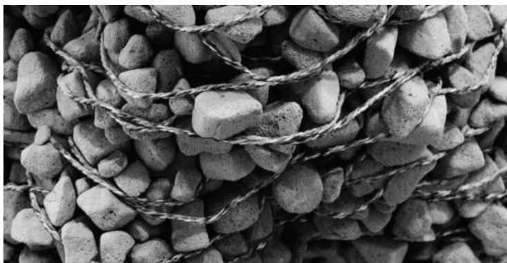
Рис.3. Rock Print - технология 3D печати, в перспективе заменяющая железобетон.
