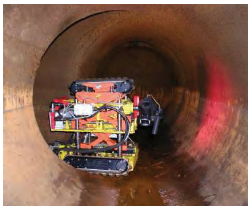
Рис.4, процентов Внутритрубный робот - дефектоскоп внутритрубная ТДК.
