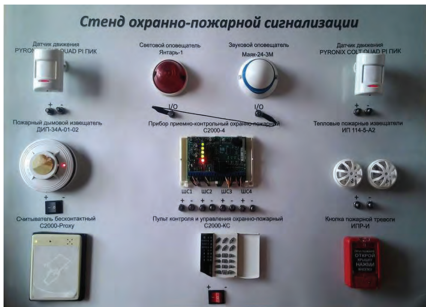
Рисунок 1 – Лабораторный стенд охранно - пожарной сигнализации
