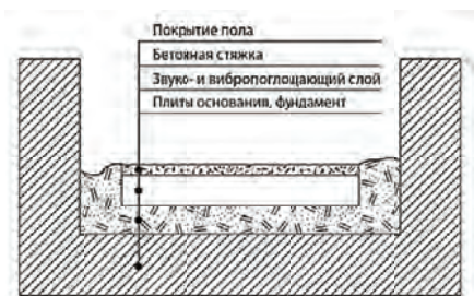
Рисунок 1. Схема виброзвукопоглощающего пола для крышной котельной
