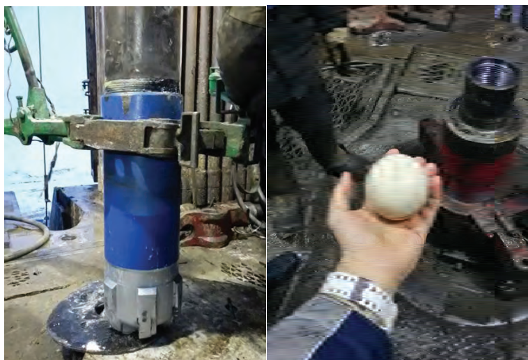
Рисунок 1 – Долото до спуска в скважину и сброс шара активации
