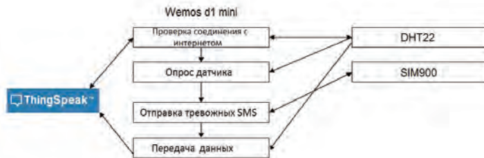
Рисунок 1 – Структурная схема подключения компонентов датчика
