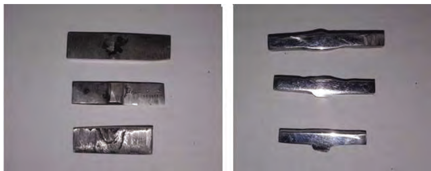
Рис.2 . Внешний вид микрошлифов зон сварочного соединения трубы из стали 15X5M (а – внешний вид микрошлифа сварного шва после вырезки из трубы , б – готовый полированный микрошлиф ).
