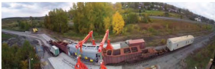
Рис. 7 Перегрузка генератора на ж / д сочлененный транспортер
