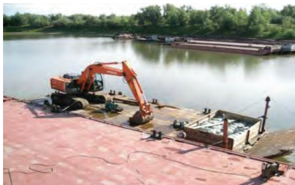
Рис.8 размещенный на барже экскаватор с ковшом и грейфером
