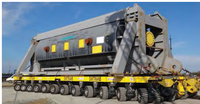
Рис.4 Техника, использованная для организации автомобильной перевозки и РО - РО выгрузки КТГ
