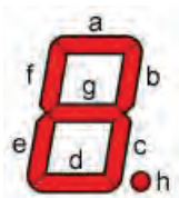
Рис.5. Внешний вид одноразрядного семисегментного индикатора
