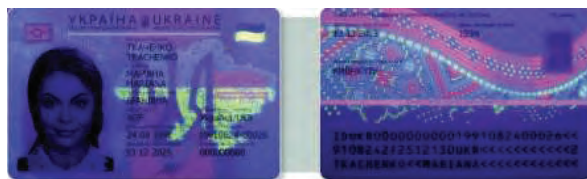
Рис. 6. Лицевая и оборотная стороны паспорта гражданина Украины в виде ID - карты под воздействием источника УФ - излучения
