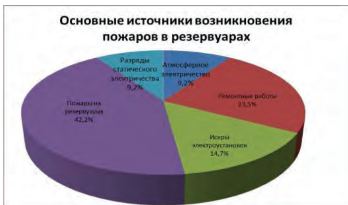
Рисунок 3. Основные источники возникновения пожаров в резервуарах
