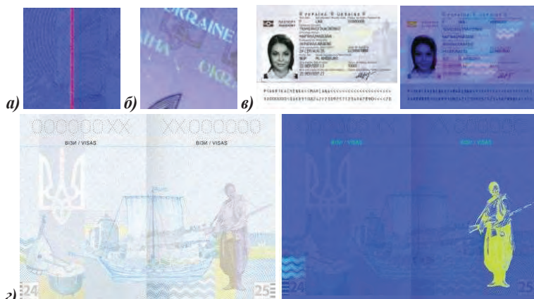
Рис. 5. Заграничный украинский паспорт в УФ - лучах: защитная нить (а), скрытый текст (б), страница данных (в), бумажная страница (г)
