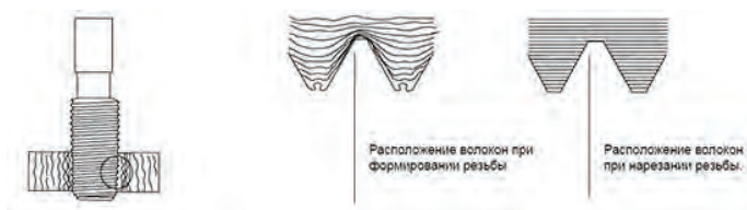
Рисунок 11. Сравнительные схемы формирования профиля резьбы бесстружечным и стружечным метчиками
