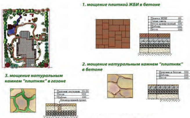
Рис. 1. Элементы и конструкции декоративного мощения.
